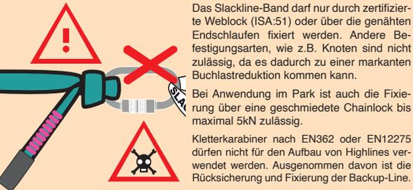
Das Slackline-Band darf nur durch zertifizierte Weblock (ISA:51) oder über die genähten Endschlaufen fixiert werden. Andere Befestigungsarten, wie z.B. Knoten sind nicht zulässig, da es dadurch zu einer markanten Buchlastreduktion kommen kann.
