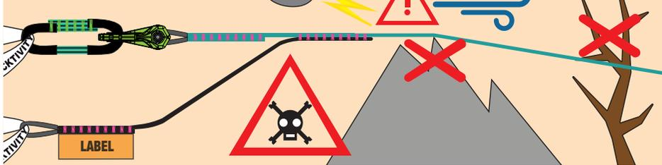
Das Slackline-Band darf nur freihängend installiert werden, kein Aufliegen. Auch ist auf genügend Abstand zu Ästen und andere Hindernisse zu achten, so dass bei keiner Anwendung eine Berührung möglich ist.
