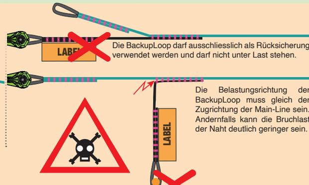
Die BackupLoop darf ausschliesslich als Rücksicherung verwendet werden und darf nicht unter Last stehen.
